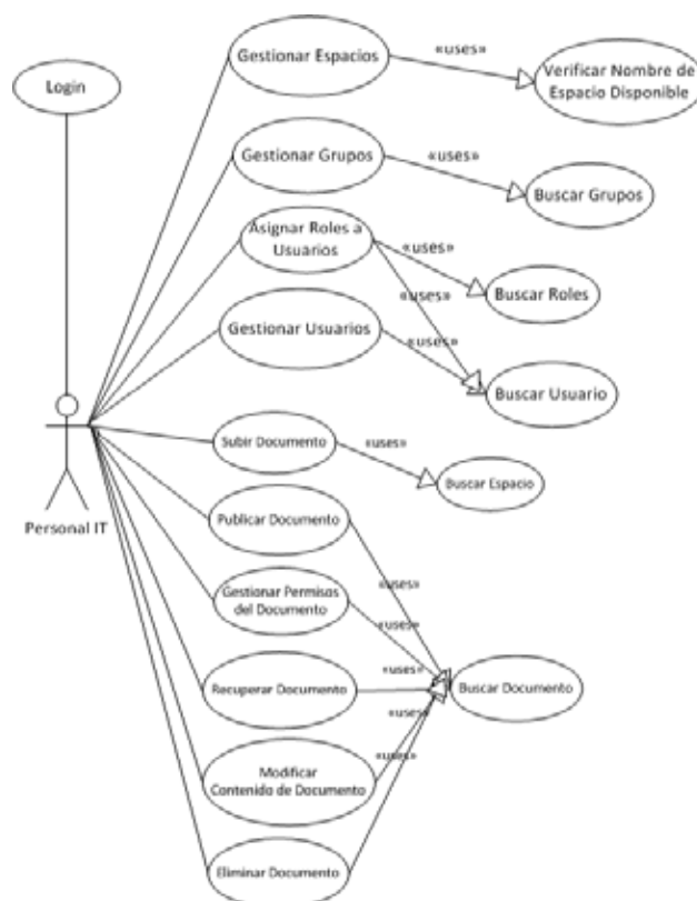
Figura 4-1 Diagrama de Caso de Uso para Personal IT incluye todas las funciones principales del Sistema (Fuente propia).
