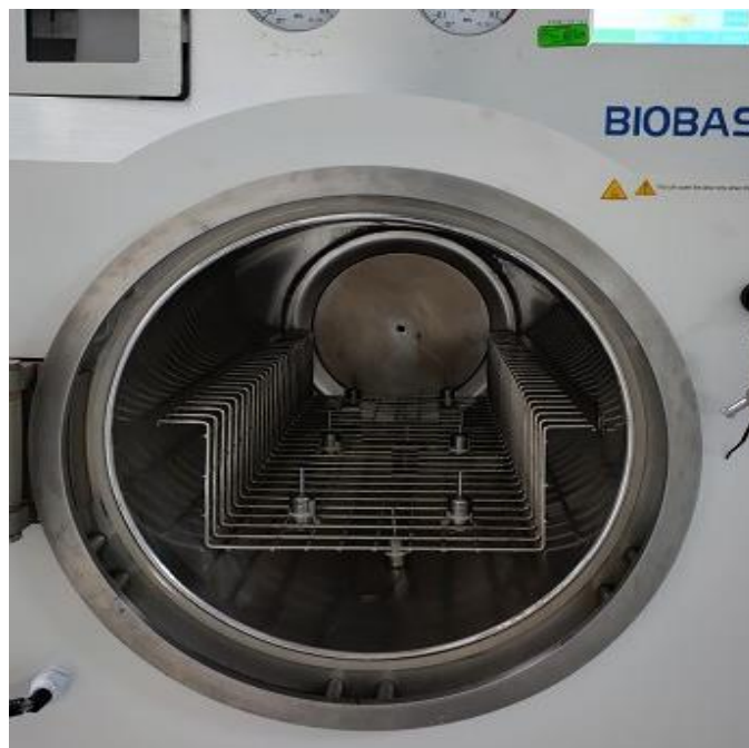
Foto N°05. Distribución de los registradores de Temperatura en la cámara vacía del Autoclave Horizontal BioBase
