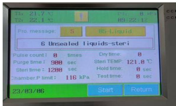
Foto N°04. Finalización de un ciclo de Esterilización con los parámetros configurados para la esterilización en medios de cultivo en el Autoclave Horizontal BioBase Modelo
