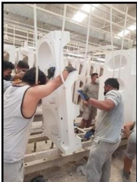
Figura 18. Momento en el cual los operarios inclinan los moldes de forma horizontal, para que pueda encajar perfectamente en la plataforma de los rieles de moldes.
