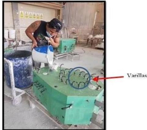
Figura 5. Proceso en el cual consiste en realizar el llenado del yeso líquido a la matriz de moldes. |
