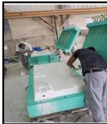
Figura 6. Proceso en el cual consiste en retirar la rebaba de yeso en el molde.
