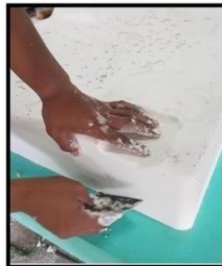
Figura 7. Uso de cuchilla para facilitar el retiro de la rebaba del yeso en el molde
