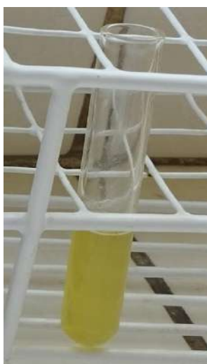
Figura N ° 55: Tubos de ensayo: tubo MP y el segundo, tubo, contiene la Rx. con \text{FeCl}_3 3%.
