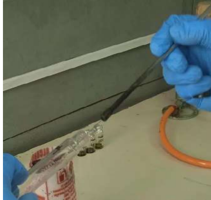
Figura N ° 86: Introduciendo el asa de Kolle que contiene cepas de Escherichia coli ATTC® 25922™, en el suero fisiológico.
