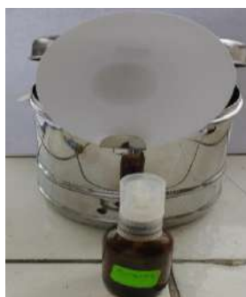
Figura N ° 56: Papel filtro con solución de acetato de magnesio al 5% secado previamente a 90 °C observado en la lámpara UV365nm.
