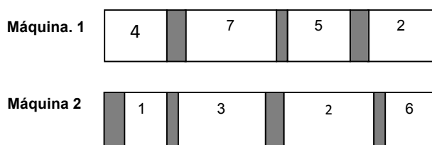
Figura 1: Ejemplo de asignación y secuenciación en dos máquinas.
