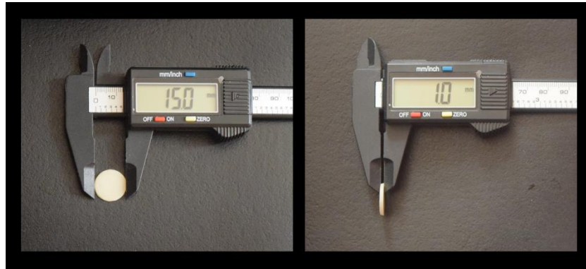
Figura N° 1. Dimensiones de las muestras, acorde a la ISO 4049.
