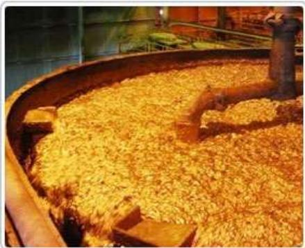
*Nota.* Flotación del concentrado de cobre. (Southern Perú - a, 2018)
