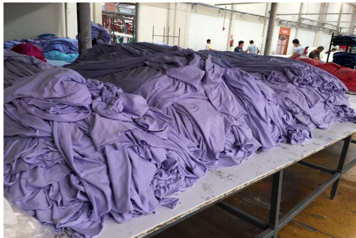
Ilustración 24: Proceso de reposo de tela
