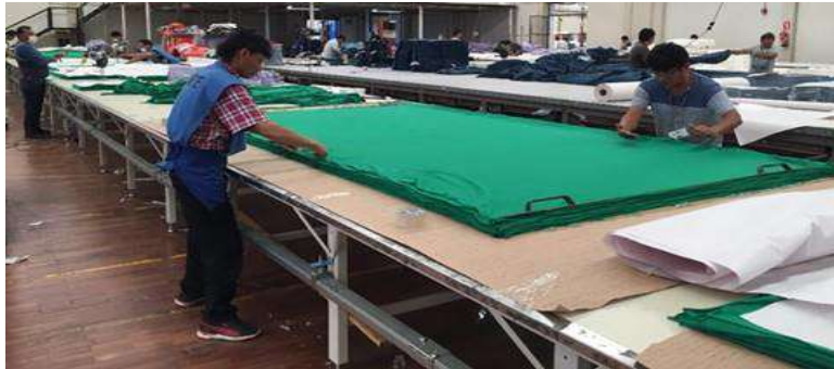
Ilustración 26: Proceso de tendido
