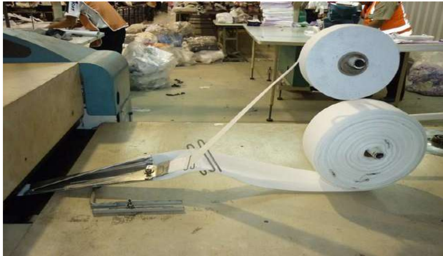
Ilustración 34: Máquina Fusionadora con Diseño de Dispositivo
