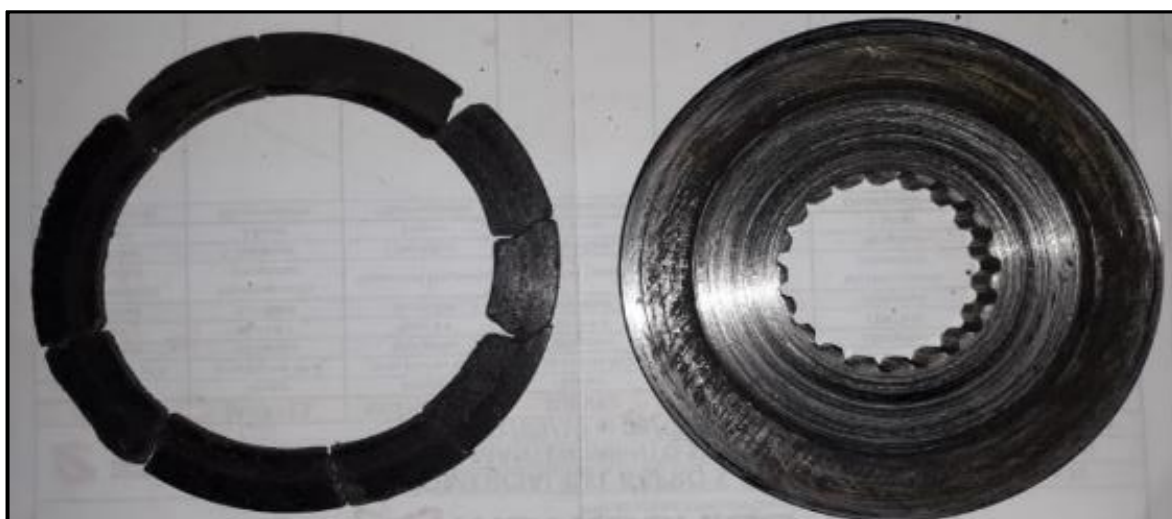
Figura 42: Discos de freno dañados Fuente: Elaboración propia
