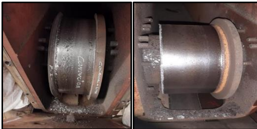
Figura 50: Ruedas testeras dañadas Fuente: Elaboración propia
