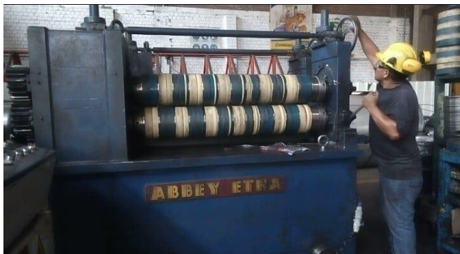
Figura 42 Colocación y ajuste de tuerca de cabezal de corte
