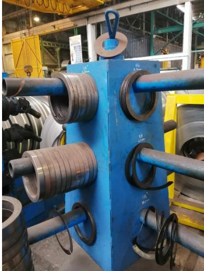
Figura 53 Estructura para guardado de cuchillas
