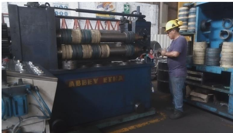
Figura 40 Montaje de cuchillas, separadores y jebes
