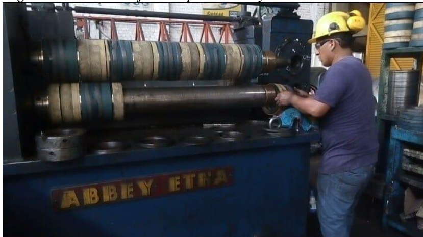
Figura 37 Desmontaje de separadores y cuchillas
