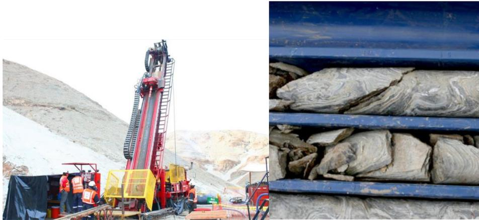
Figura N° 05 y 06: Máquina Perforadora Diamantina
