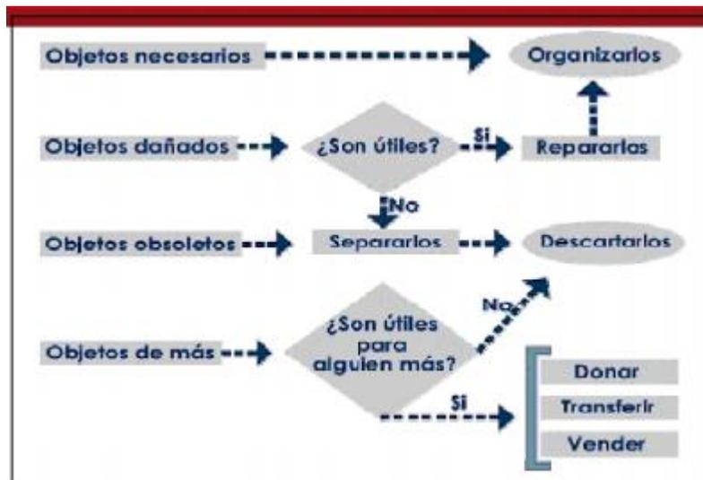
Figura 11: Diagrama de flujo para clasificación 5'S
