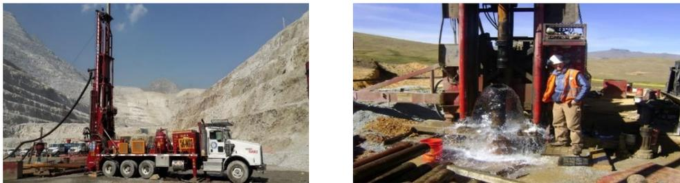
Figura N° 03 y 04: Máquina Perforadora foremost DR24.
