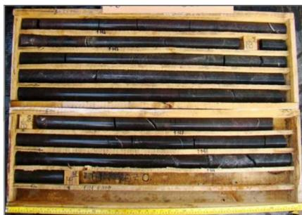
Figura N° 10: muestra de mineral de perforación diamantina
