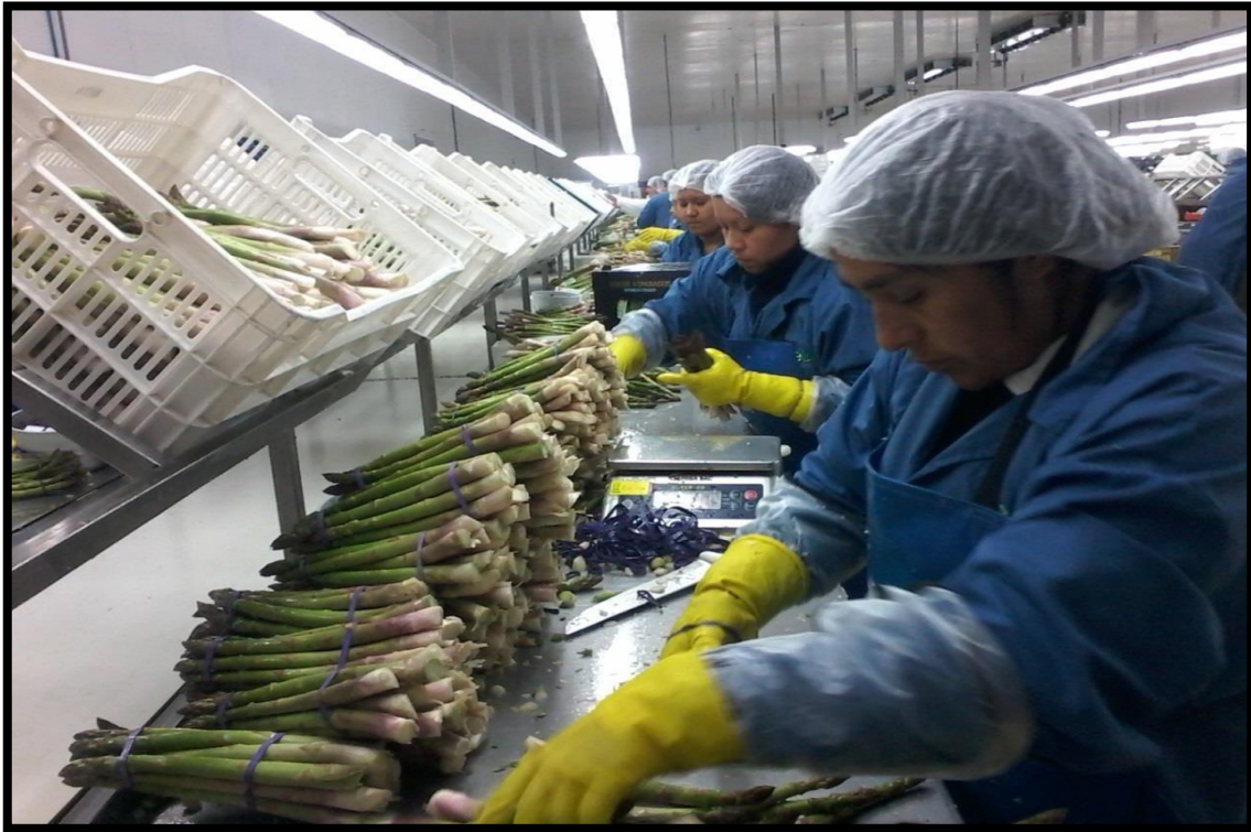
Figura 21. Etapa de corte, enligado, pesado y empaçado
