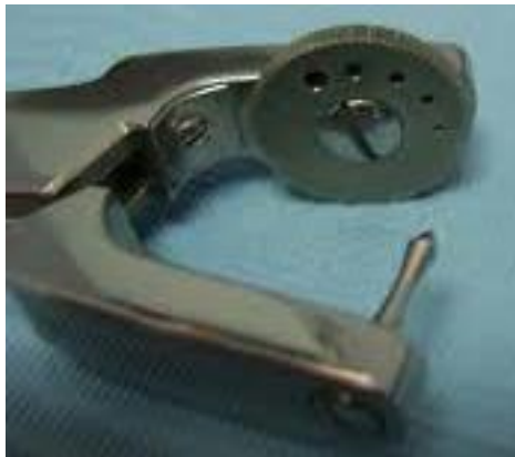
Figura 21 Con presencia de 5 agujeros para diversas medidas de perforaciones.
