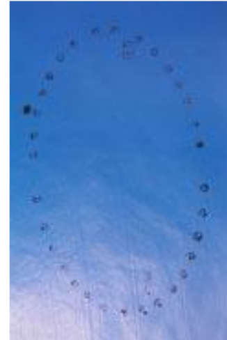
Figura 26 Goma Dique con diferentes Perforaciones.
