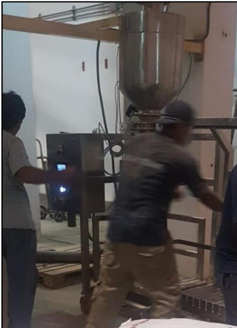
*Figura 35: Operarios sin EPP en Embolsadora
