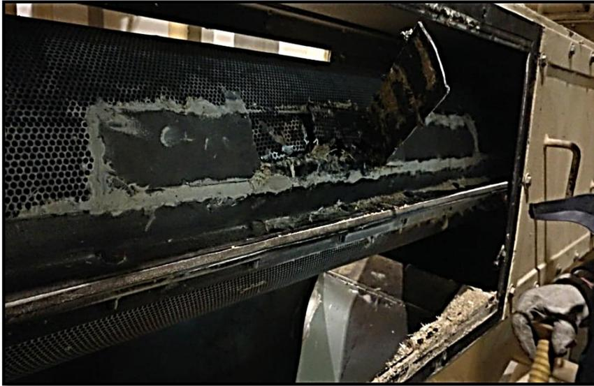
*Figura 33: Problemas técnicos en la malla de la trilladora*
