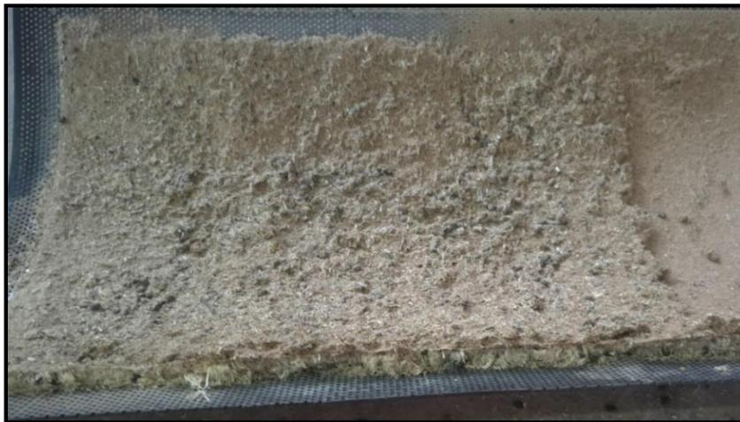
*Figura 31: Empaste de las mallas de trabajo ocasionado por tara húmeda
