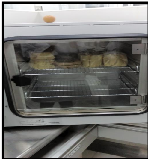
Foto N°11. Conservación de la siembra en la estufa a 37°Cx 24 a 48 horas.
