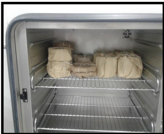
Foto N°7. Colocación de las placas en la incubadora a 37°C por 48 horas.
