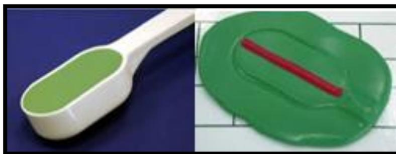
**FIG.20 TOMAR LA PORCIÓN DE SILICONA ADECUADA, COLOCAR 2 LINEAS DE CATALIZADOR DEL TAMAÑO DE LA CUCHARA MEDIDORA**
