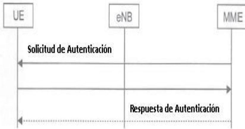
Figura 2.3 Procedimiento de autenticación de usuario (Adaptado de: Rumney, M. 2010)
