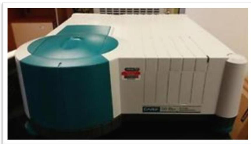
Figura 16: Equipo Espectrofotómetro UV.
