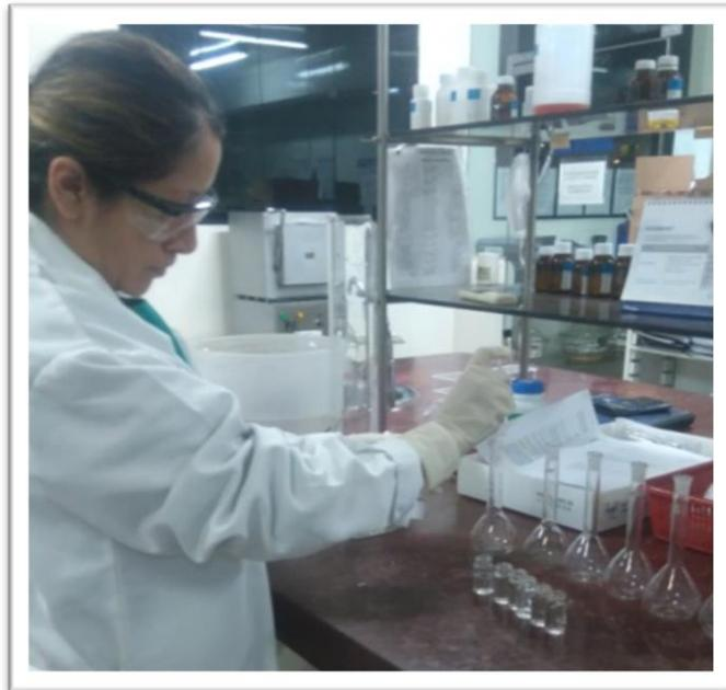
Figura 15: Analista realizando el análisis de disolución.
